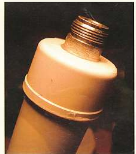
Overtollige kit bij het chassisdeel en de buis verwijderen en gladstrijken.
